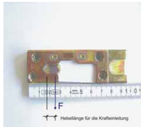
Bild 4 Ungünstiger Einschluss des Zapfens
